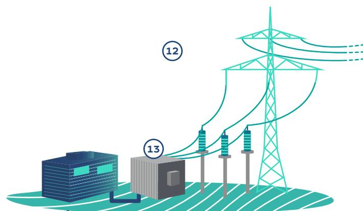
All'interno della Sottostazione risiede il **Sistema informativo di controllo generale di supervisione e acquisizione dati**, noto come **SCADA**. <sup>14</sup> Questo sistema permette il **monitoraggio in tempo reale** del funzionamento delle turbine e la gestione delle anomalie anche da remoto.
